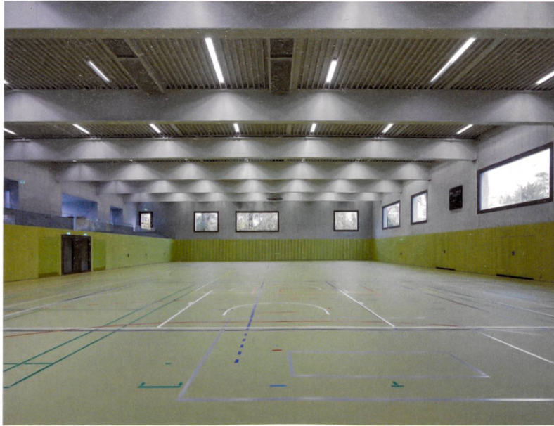
Im Hallenraum harmonisiert der graue Sichtbeton mit den zurückhaltenden Farben der Holzlattung, die als Akustikverkleidung dient.
