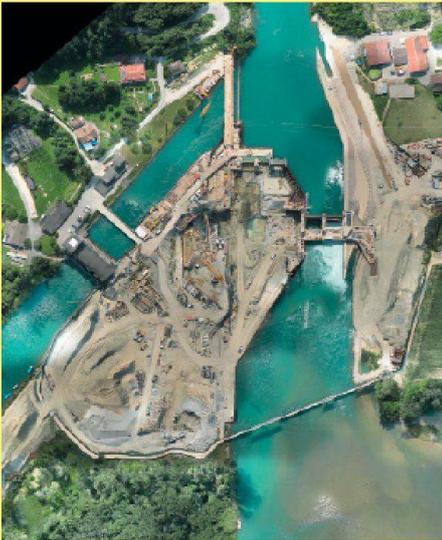
**01** Am bestehenden Hagneckkanal wurde das alte Wehr abgerissen; bis 2015 werden ein neues Wehr sowie ein neues Krafthaus mit zwei Turbinen für die Kraftgewinnung gebaut. Im alten Kraftwerk, das unter Denkmalschutz steht, bleibt nur eine Turbine von ehemals fünf in Betrieb. Weiter entstehen eine Boottransportanlage zwischen Bielersee und Hagneckkanal sowie ein Umgehungsgerinne für den Fischeaufstieg. (Foto: Bielerseekraftwerke AG)
