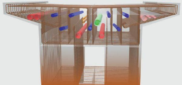
Die Brücke Oberwasser dient nicht nur der Erschliessung des Kraftwerks, sondern ist gleichzeitig die Verbindung für die Energieableitung mit einer Vielzahl von Rohrleitungen.
