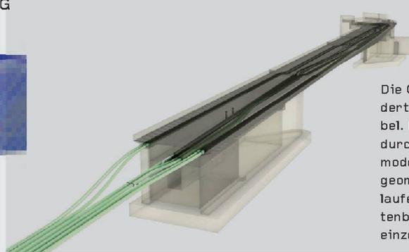
Die Geometrie der Oberwasserbrücke erforderte massive Bewehrungseisen und Spannkabel. Die beengten Platzverhältnisse konnten durch Überlagerung der einzelnen 3-D-Teilmodelle (Koordination Werkleitungen, Rohbau-geometrie und Bewehrung) sowie durch den laufenden Abgleich gelöst werden. Einzelknotenbetrachtungen sind mehrfach zwischen den einzelnen Planern ausgetauscht worden.
