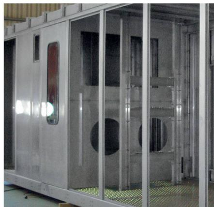
Die Funktionscontainer von Elkuch Eisenring ersetzen Räume in immissionsreichen Umgebungen, also bei starkem Lärm, hoher Verschmutzung oder bei Extremtemperaturen. Statt eines aufwendigen Innenausbaus lassen sie sich in «unwirtliche» Produktionsumgebungen integrieren und sorgen für zuverlässig ausgeführte Prozesse. Als Gebäudeersatz wird ein Container dann ver-
