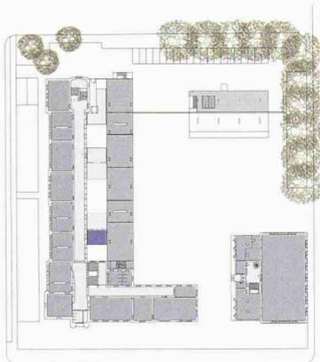
**Der Neubau ist parallel zum Südtrakt angeordnet. Im langen Lichthof verbinden Plattformen die neuen Räume mit der bestehenden Erschliessung (2. Rang, Matti Ragaz Hitz)**
