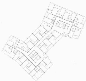
Erdgeschoss mit einem Zugangshof. Im Normalgeschoss (1.–4. OG) sind bis zu 17 Ein- und Zweizimmerwohnungen um die Erschliessung angeordnet (Zur Weiterbearbeitung empfohlen, Miller & Maranta)
