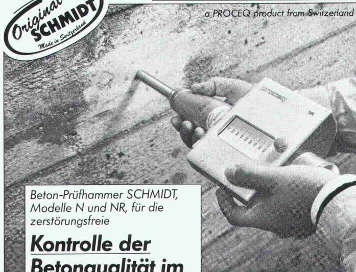
Beton-Prüfhammer SCHMIDT, Modelle N und NR, für die zerstörungsfreie
