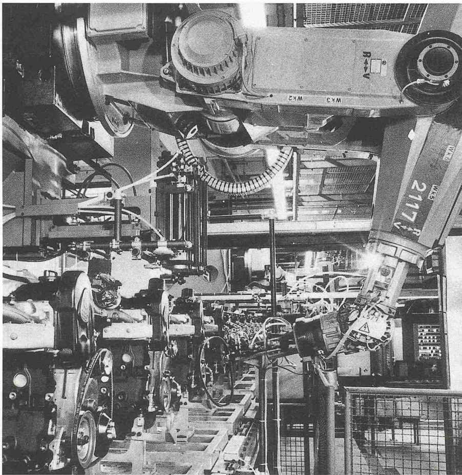
Bild 20. Automatische Fahrzeug-Endmontage bei VW. Blick in den Bereich «automatisches Auflegen, Spannen und Festziehen des Keilriemens» in der Halle 54. (Werkbild VW)
