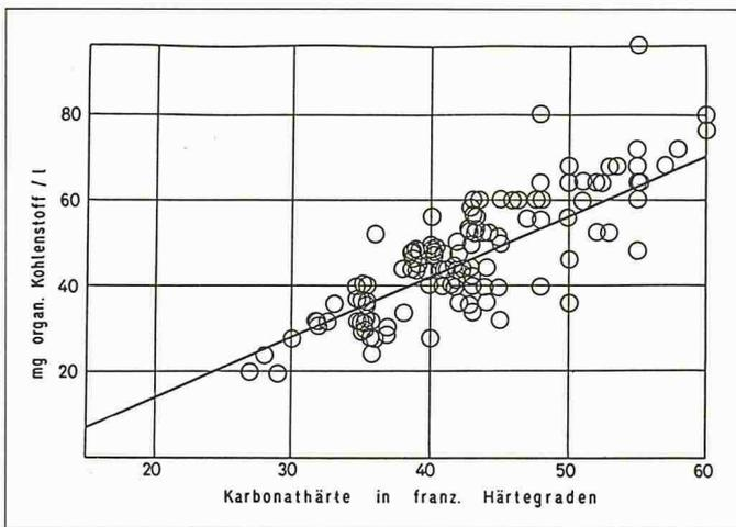
Bild 2. Der Eintrag von abbaubarem, organischem Material ins Grundwasser bedingt eine signifikante Aufhärtung. Das durch die Oxidation des organischen Materials entstandene  $\text{CO}_2$  reagiert mit dem Kalziumkarbonat
