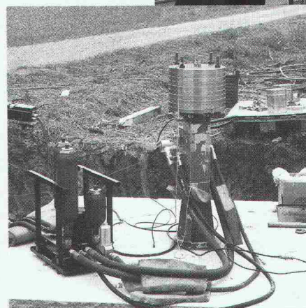
Schwingungserregung einer Fundamentplatte.
