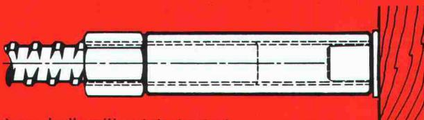
Gewi-Muffenstoss, halbseitig einbetoniert
