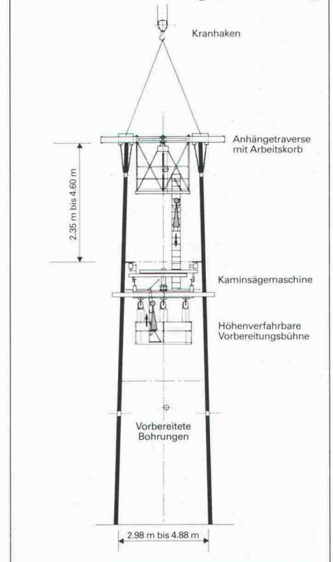
Objekt. Der 92 m hohe Kamin wurde in einzelne Betonrohre von 2.35 m bis 4.60 m Länge geschnitten, welche zu Boden transportiert und dort zertrümmert wurden. Nach einer Startphase wurden zwei bis drei Elemente pro Tag demontiert.
