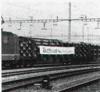
Das zementmörtelbeschichtete Gussrohr (ZM) von BUDERUS setzt sich auch in der Schweiz für Trinkwasserdruckleitungen immer mehr durch. Die ZM-Beschichtung besteht nur aus den Basisstoffen Quarzsand, Zement
