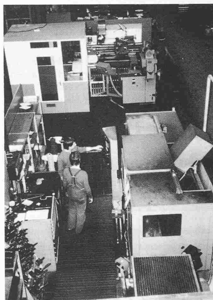
«Autonome Fertigungsinsel» mit Bearbeitungsmaschinen. Hinten links die Steuerkabine mit Rechneranschluss für Programmierung und Auftragsplanung
