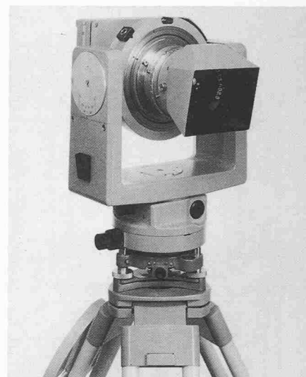
Bild 3. Fotokamera Wild P31 f = 100 mm; Aufnahmeformat 10 \times 12 cm
