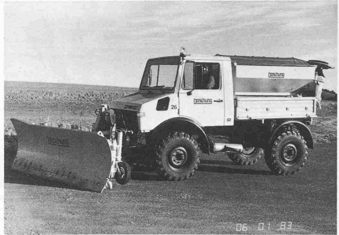
Bild 7b. Mehrscharfederpflug (Ansicht)
