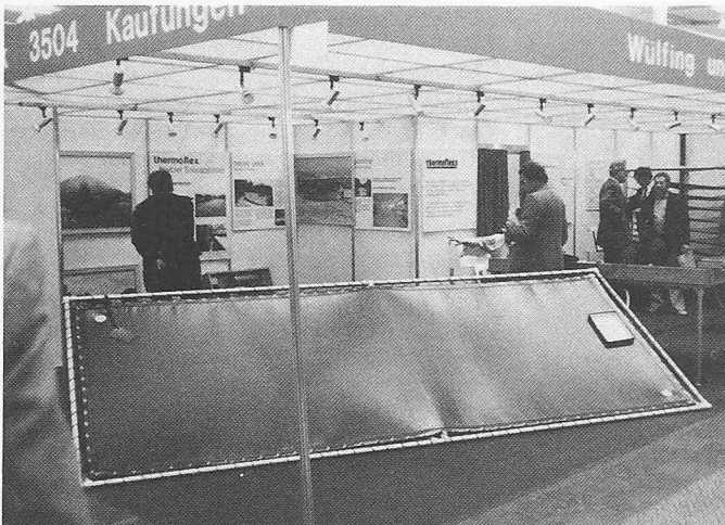
Wärmetauscher zur Absorption von Wärme aus der Umwelt
