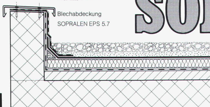
Schutzschicht SOPRALEN EJ 3.5 + EV 3.2 Wärmedämmschicht Dampfsperre
