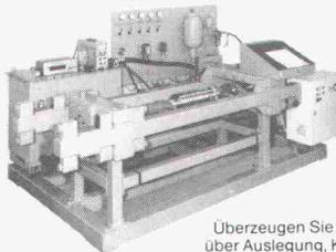
Ablieferungstests auf eigenen dynamischen Prüfständen sind für uns selbstverständlich. Und damit Sie auch in Ihrer Anlage testen und prüfen können, halten wir für Sie eine mobile und kompakte Hydropulsanlage bereit.
