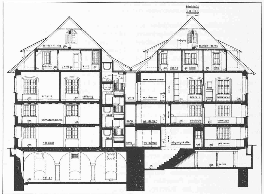
Schnitt durch das Hauptgebäude
