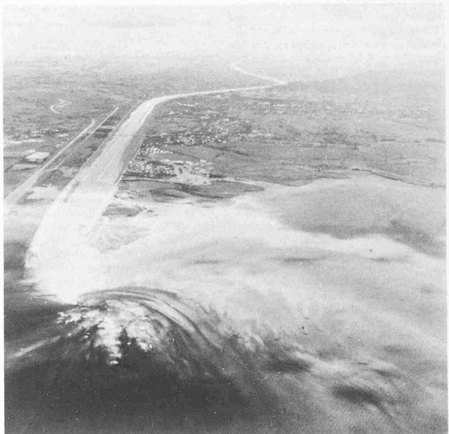
Bild 8. Einmündung des Rheins in den Bodensee bei Hochwasser. Der Grossteil der Schwebstoffe lagert sich unmittelbar beim Eintritt in den See ab, der Rest wird seitwärts verdrifft
