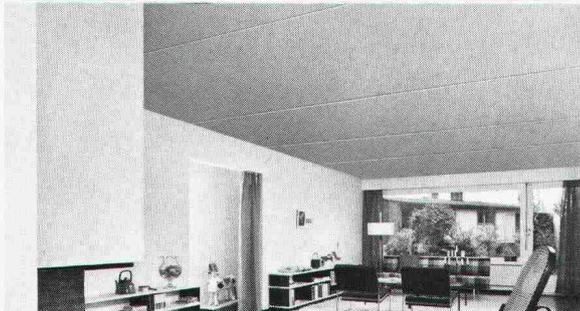
PRELAM-Deckenplatten sind grossflächige, vorgefabrizierte Deckenelemente, welche die Funktionen der Schalung, der Hauptarmierung und des Verputzes übernehmen.
