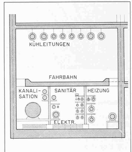
Schnitt durch den Erschliessungsring
