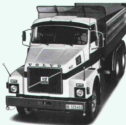
Erprobtes Volvo-Doppelachs-Aggregat mit progressiver Stahl-Gummifederung. Speziell geeignet für den harten Baustelleneinsatz.
