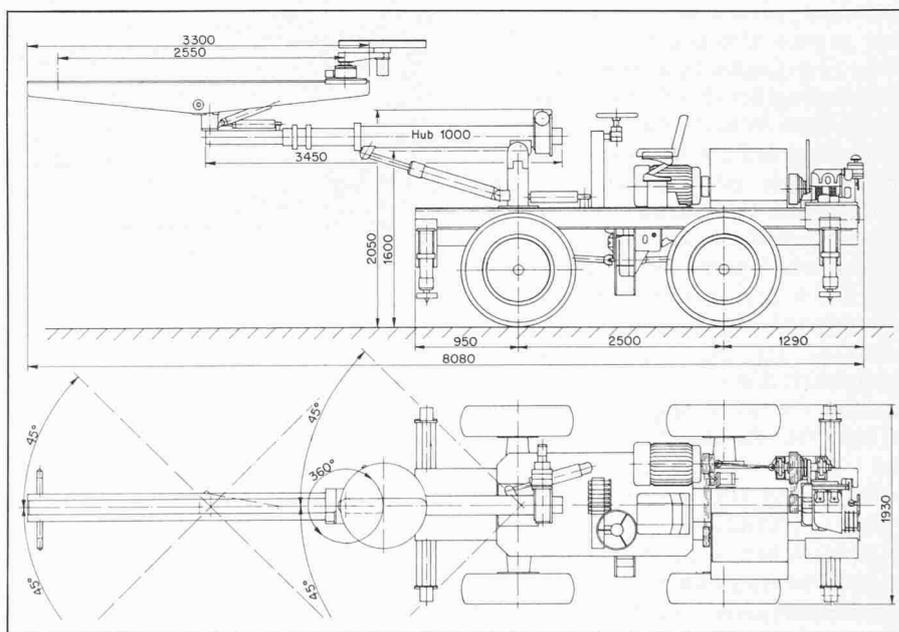
Bild 1. Steinsägemaschine mit Teleskoparm. Grundriss und Aufriss
