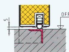
Bodenanschluss mit Magnetdichtung 5)
