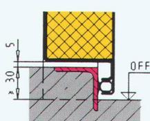
Bodenanschluss mit ansenkbarer Dichtung 4)
