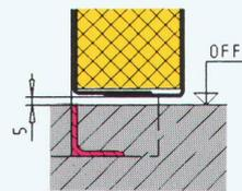
Bodenanschluss mit Anschlag und Dichtung 3)
