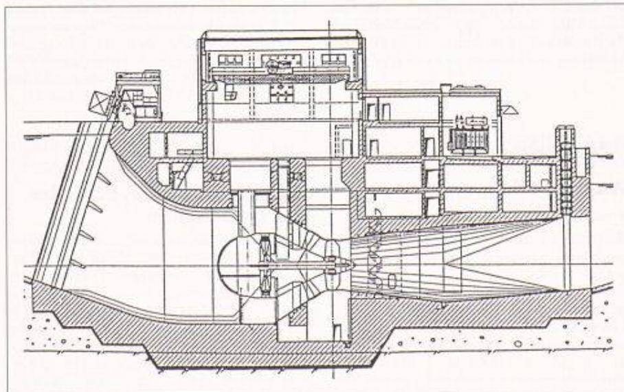
Längsschnitt durch die neue Maschinenzentrale
