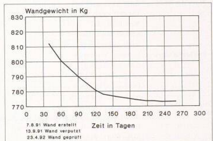
Bild 7. Austrocknungsverlauf der Prüfwand während der Lagerung bis zur k-Wert-Prüfung
