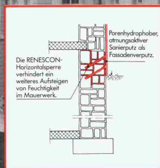
**NEU.** Die Mikrowelle trocknet das Porengefüge aus. Mehr Injektionsflüssigkeit wird aufgenommen. Resultat – zusammen mit flankierenden Massnahmen – absolut trockene Mauern.
