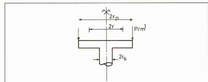
Bild 10. Durchstanzen von Flachdecken: Ersatzplatte und Belastung
