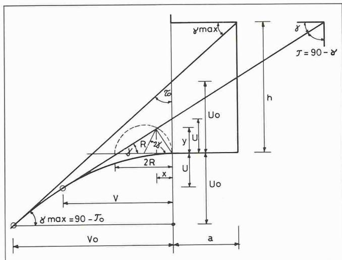
Bild 5. Konstruktion des variablen Druckneigungswinkels  $\gamma$
