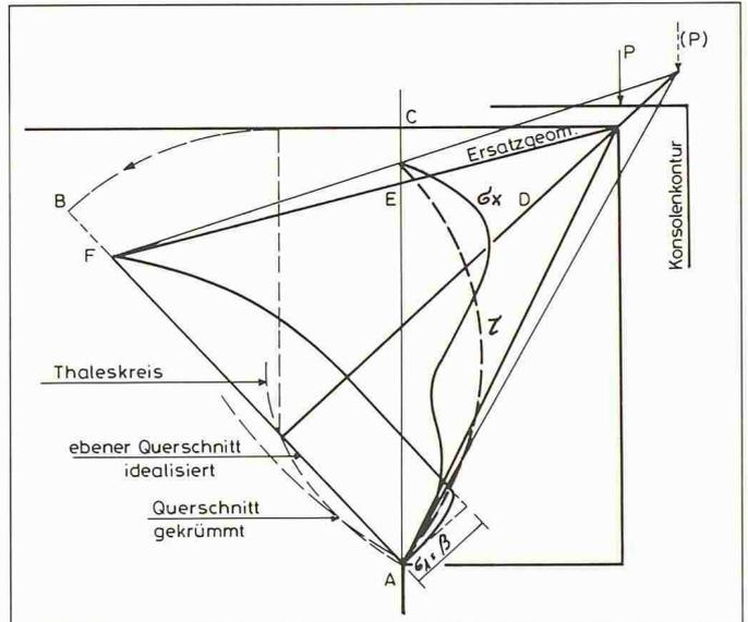
Bild 2. Spannungsverlauf in der Konsole  $a/h = 0,5$  unter theoretisch maximaler Belastung
