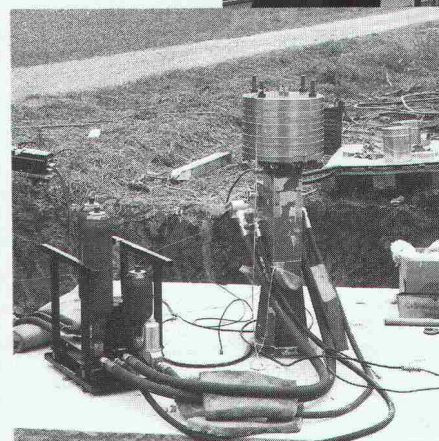
Schwingungserregung einer Fundamentplatte.
