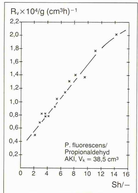
Der Stoffübergang ist zuvor in dem entsprechenden Rieselbett durch absorptionskinetische Untersuchungen bestimmt worden. In Tabelle 4 ist die ermittelte Modellgleichung für die Sh-Zahl als Funktion der Re-Zahlen der fluiden Phasen sowie der Sc-Zahl dargestellt.
