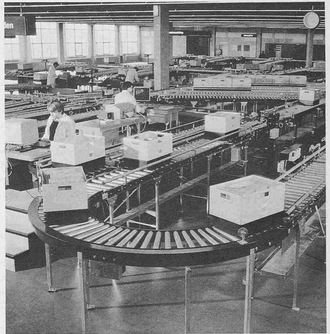
Bild 13. Als Subsystem übernimmt jede Förderanlagensteuerung einen Teilbereich einer solchen Anlage. Hier sind die Behälter codiert und werden mit Laser-Scannern in ihrem Bewegungsablauf überwacht
