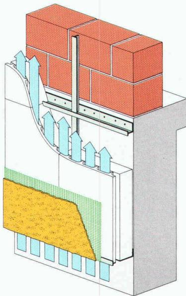
Auf dem Mauerwerk werden mittels Trägerschienen STO-Wärmedämmplatten mit vertikaler Hinterlüftung als thermische Isolation montiert. Durch diese Hinterlüftung wird allfällig auftretender Wasserdampf problemlos an die Aussenluft abgegeben. Und aussen wird die Fassade im traditionellen Stil verputzt. Mit einem Verputz-System, das wir von Stotmeister in diversen Strukturen, Körnungen und Farben in unserem Werk in Niederglatt/ZH herstellen.
