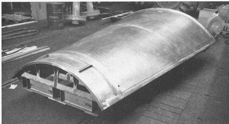
Bild 4 (oben). Fertiggestellte konische Form
