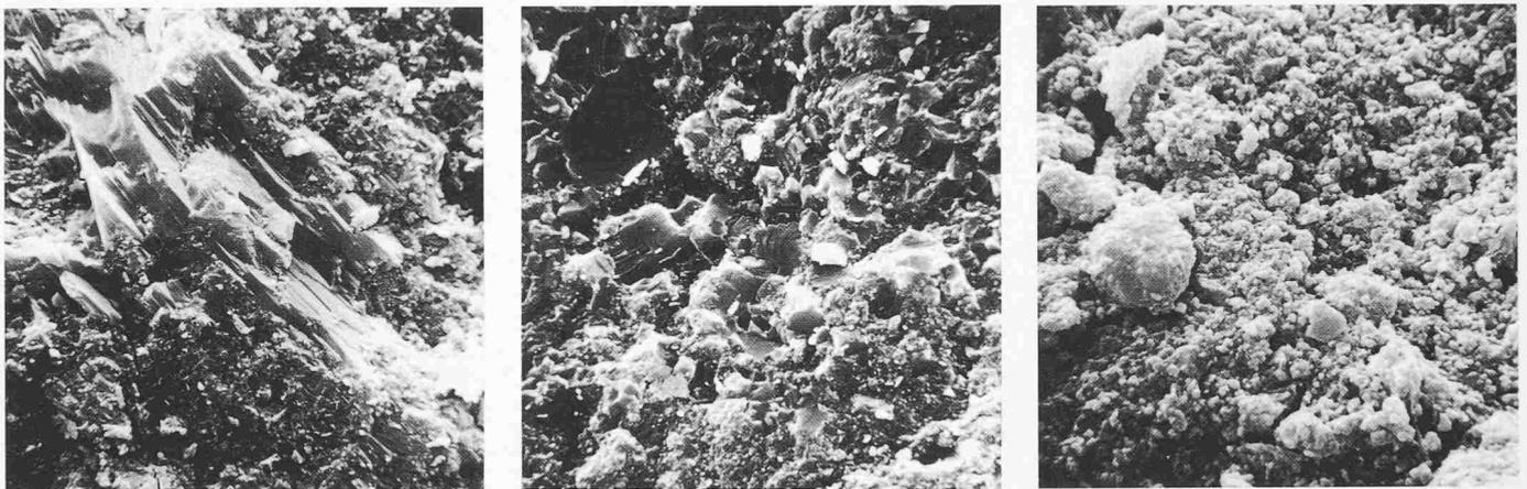
Bild 6. Mikrogefüge von erhärteten Pasten aus PC, HK und AS Typ B. Aufnahme mit dem Rasterelektronenmikroskop (REM). Vergrößerung 1400 ×
