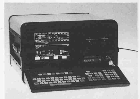
Bild 4. Programmier- und Steuergerät (Modicon). Power-flow als Servicehilfe
