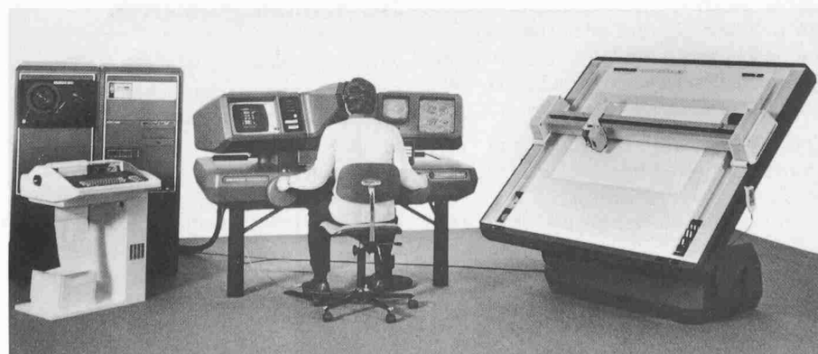
Bild 7. Aviolyt AC 1 mit Aviotab TA 2 (Wild); modernes System mit analytischem Stereoplotter; alle fotogrammetrischen Auswertungen laufen über ein einziges Steuergerät
