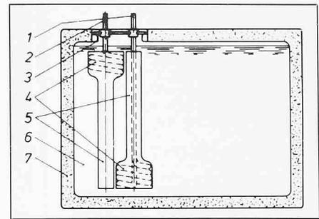
Druckloser Kunststoff-Wärmespeicher. 1 Lötanschluss Beladewärmetauscher, 2 Lötanschluss Entladewärmetauscher, 3 Dom Ø 420 mm, 4 Wärmetauscher, 5 Steig- bzw. Sinkkamin, 6 Speichermedium (z.B. Wasser), 7 Isolation
