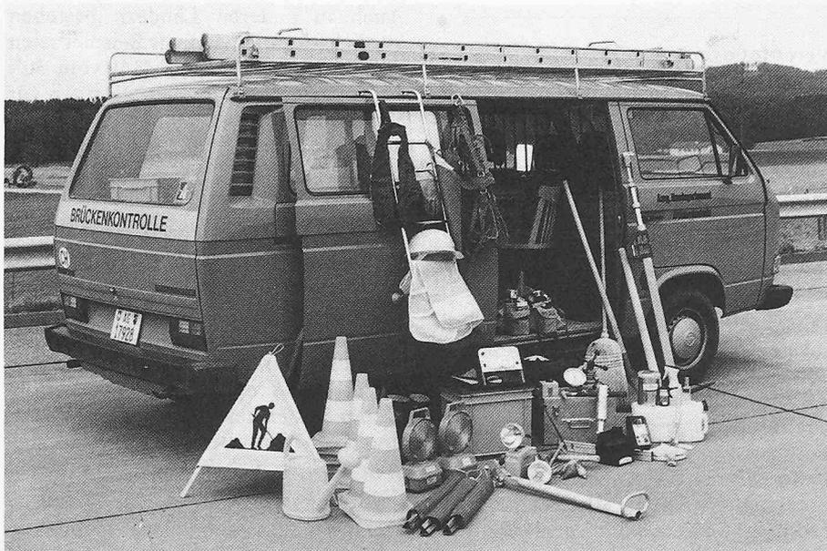
Bild 1. Fahrzeug und Gerät zur Brückenkontrolle
