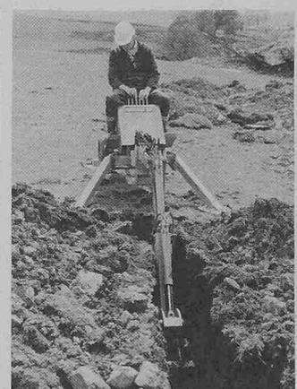
Benzinmotor betätigt den hydraulischen Antrieb.
