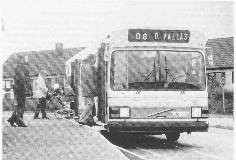
Der Bus wird mit Hilfe eines elektronischen Steuersystems an der Haltestelle eingelenkt und abgebremst. Beim Öffnen der Türe wird eine Rampe ausgefahren, die das Ein- und Aussteigen ohne Stufen ermöglicht
