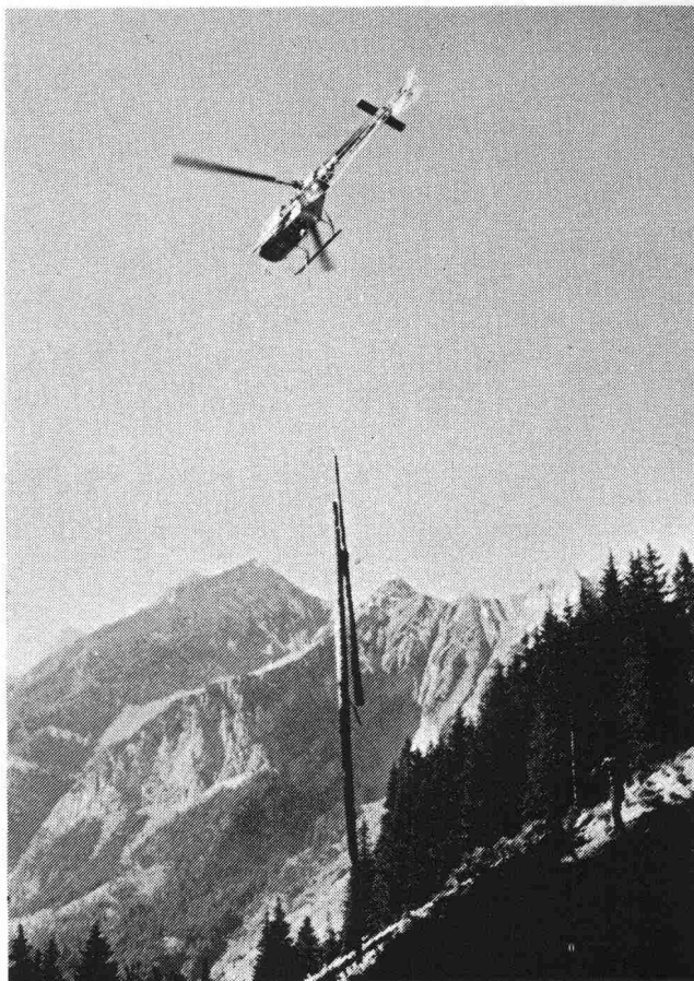
Ein Helikopter vom Typ SA 315 B Lama der Heliswiss fliegt Holz vom Schlag in einem steil abfallenden Berghang auf 1565 m/M zum 200 m tiefer gelegenen Lagerplatz am Ende der Alpstrasse.
