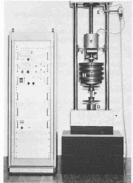
Bild 2A. Hochfrequenz-Prüfmaschine Amsler Type 10 HFP 1478 (Pulsator) mit zugehörigem Steuer-schrank für die elektronische Regelung der Maschine.
