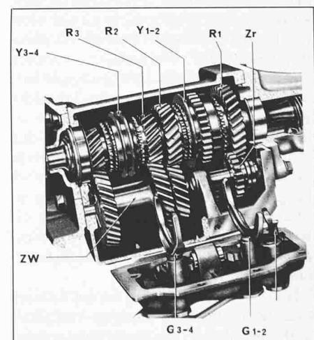
Bild 15. Blick in das Innere eines Ford-4-Gang-Vollsynchron-PKW-Getriebes
