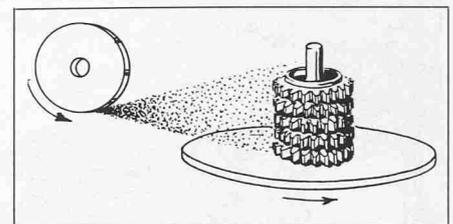
Bild 16B Das Shot-peenen von Zahnrädern mit Stirnverzahnung auf den Satellitendrehmaschinen einer mit einem Schleuderrad ausgerüsteten Drehtischmaschine, wobei die Stirnräder in Paketen auf die im Drehzentrum der Satellitentische montierten Dorne aufgesteckt werden
