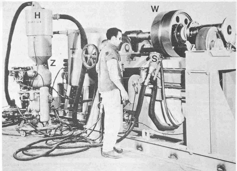
Bild 24. Nach dem Vacu-Blast-System arbeitende Anlage zum Shot-peenen von gepfeilten Helikoid-Doppel-Zahnradern bis 800 mm Durchmesser für Dampfturbinen-Reduktionsgetriebe grosser Leistung. Die ganze Zahnbreite wird automatisch mehrfach bestrichen, da sich das Zahnrad dreht, während der Blaskopf eine hin- und hergehende Bewegung parallel zur Rotationsachse ausführt.
