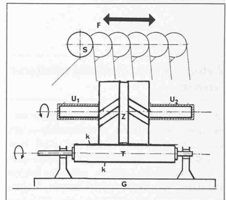
Bild 25. Schematische Darstellung der Arbeitsweise einer mit einer hin- und hergehenden Schleuderradeinheit ausgerüsteten Maschine zum Peenen von Getriebezahnradern mittlerer Grösse.
