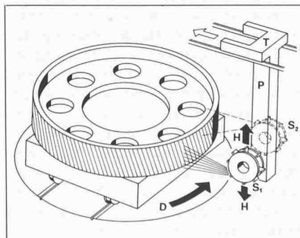
Bild 29. Schema einer Anlage zum Peenen von grossen Zahnrädern gemäss Arbeitsprinzip von Georg Fischer AG mit vergrössertem Einstellbereich durch Aufhängen der beiden Schleuderradeinheiten an einem auf dem Dach des Maschinengehäuses verschiebbar angeordneten Wagen.
