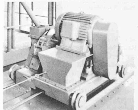
Bild 27. Auf dem Dach des Maschinengehäuses der Anlage zum Peenen von Zahnrädern mittlerer Grösse hin- und herfahrende Schleuderrad-Einheit: Strahlmittel-Zuführung mittels Teleskoprohr T
