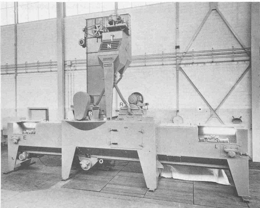
Bild 18A. Mit zwei Schleuderrädern von je 25 bis 30 PS ausgerüstete, nach dem Durchlaufprinzip arbeitende Maschine für das Peenen von Stirnrädern. Zahnradtriebwellen mit Durchschleusung der Werkstücke gemäss Schema Bild 18A.
