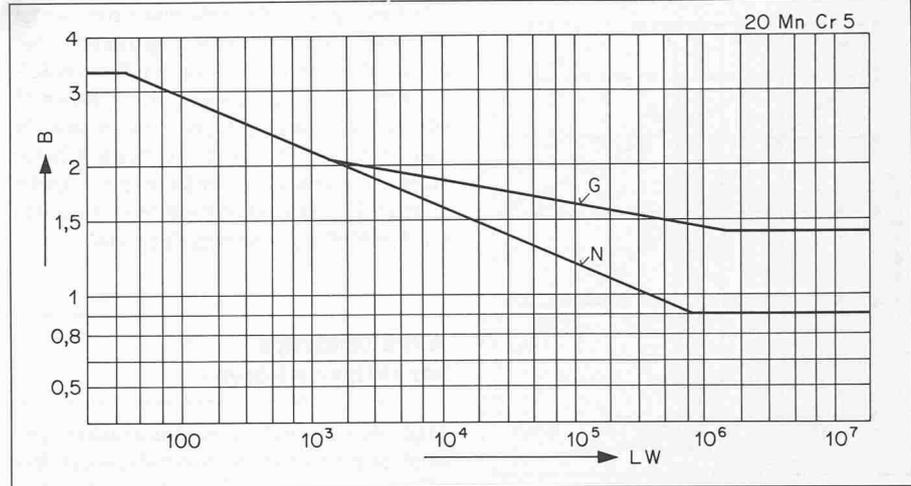
Bild 10. Lebenserwartungscharakteristik von im Einsatz gehärteten Zahnradern auf Grund einer Reihenuntersuchung über den Einfluss des Peenens auf die Dauerstandfestigkeit, mit Prüfung in einem Pulsator. Werkstoff der Zahnrad-Prüflinge: 20 MnCr 5, Zahnzahl  $z = 27$ , Modul  $m = 3$  mm, Zahnbreite  $b = 10$  mm, 20°-Normal-Verzahnung.
