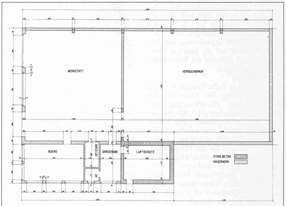
Bild 7. Die Geometrie des Grundrissplanes wurde über ein CAD-System der 2. Generation durch horizontales Schneiden des Modelles vollautomatisch erzeugt
