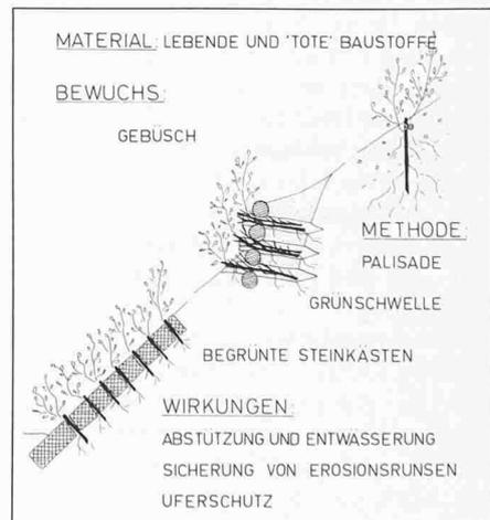
Bild 6. Kombinierte Bauweisen
