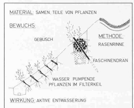
Bild 11. Biotechnische Entwässerungen
