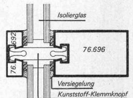
VISS = vollisoliertes Sprossensystem
