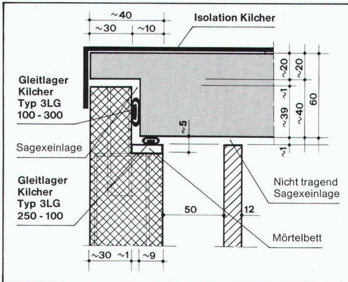
Diese elastisch gelagerte Decke ist mit **EFKAPRENE** (auf der Basis von Neoprene) der **Feuchtheitsisolation** von **KILCHER** isoliert.
