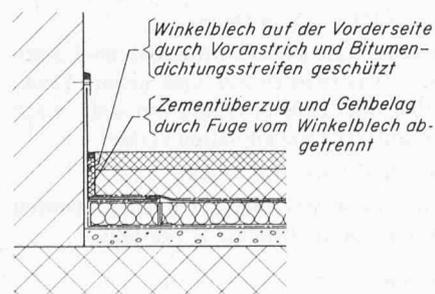
Ausführung und Konstruktion, durch die Korrosionen beim Winkelblech vermieden werden können
