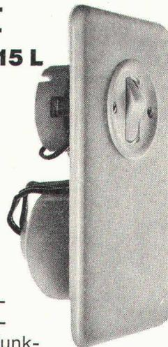
Vollelektronisch für jahrelange, störungsfreie Funktion. Standardausrüstung mit 10 Min. Nachlaufzeit, 220V, 4A, komb. mit Lichtschalter, anschlussfertig verdrahtet; auf Wunsch auch mit kürzerer Nachlaufzeit lieferbar. Passend in alle UP-Dosen. Typ AW15 ohne Lichtschalter.
