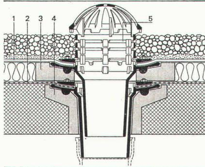
Standard-Dachablauf zweiteilig mit Isolierkörper und Isoliererring und Distanzringen. Seitlicher Auslauf 3°
