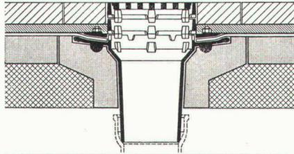
Standard-Dachablauf zweiteilig mit Isolierkörper und Isoliererring und Distanzringen 25 und 35 mm H mit Kugelrost
