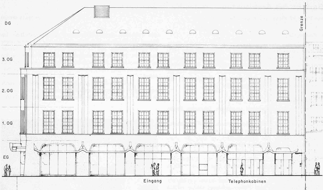
Bild 5. Fassade Füsslistrasse Massstab 1:250
